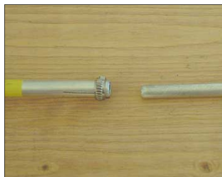
Bild 5: Bearbeiteter Übergang von 12 mm auf 10 mm Aluminiumrohr Fotos: DL3MCO
