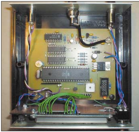
Bild 4: Ein paar Verbindungen vervollständigen den Zusammenbau des Frequenzzählers.
