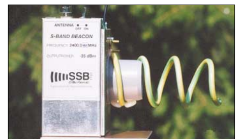
Bild 13: Kommerziell hergestellter Bakensender für 2400 MHz Fotos: DC9ZP
