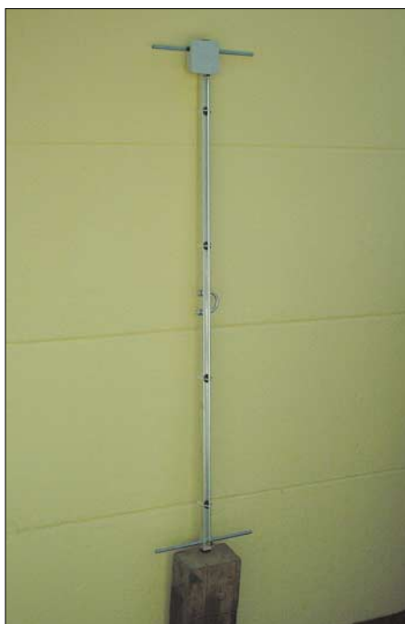
Bild 1: Fertiggestellter Boom mit zwei Gewindestangen
