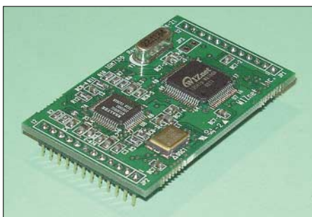
Bild 4: Das Modul IIM7100 besitzt einen eigenen Controller und wird über eine serielle Standardschnittstelle angesteuert.
