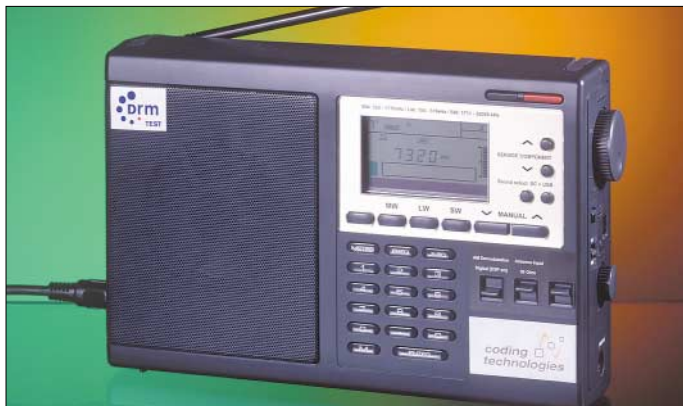
Auch der gerade eingeführte digitale Rundfunk DRM – hier ein Weltempfänger von coding technologies – ist anfällig für Störungen durch In-Haus-PLC.
